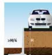
CLF10GSRZ charges standard 10 kN/m² trafic léger 3,5 tonnes max.
